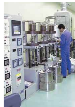
高温高圧水中での応力腐食割れ検査
