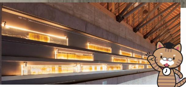
ボーリングした泥を専用の樹脂で固め薄くスライスし、ステンドグラスにした展示。1年平均0.7mmの層が、約7万年分で45m。よく見ると地震や洪水などの自然災害の跡がわかり、一枚ずつ数えることでその年代がわかります。
